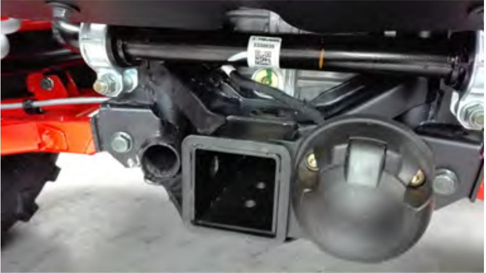
Bei Anhängermodellen neuerer Bauart werden alle 7 Anschlusskontakte des Steckverbinders genutzt. Ein Anhängermodell älterer Bauart ist mit diesem Steckverbinder eventuell nicht kompatibel.
